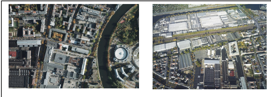
Abb. 3. Senkrechtluftbild aufgenommen mit Vexcel UltraCam Xp (links) Schrägluftbild aufgenommen mit AOS-Kamera (rechts)
